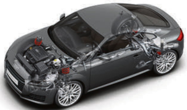
Der Allradantrieb am Beispiel des Audi TT Quattro.
