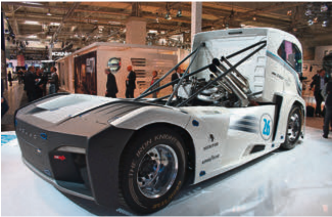
Der schnellste LKW der Welt: Dank 13 Litern Hubraum und 2.400 PS schafft der Volvo „Iron Knight“ eine Höchstgeschwindigkeit von 276 km/h!
