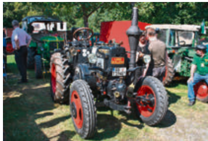
Auf Hochglanz polierter Lanz Bulldog von 1940 mit 4,7 Liter Glühkopf und 20 PS.
