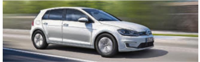
leistungen legen dadurch zu: Für den Sprint auf 100 km/h benötigt der Elektro-Golf 9,6 Sekunden, und die Höchstgeschwindigkeit steigt auf 150 km/h.
