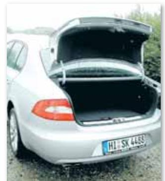
Praktisch: die patentierte Twin Door. Entweder den Kofferraumdeckel oder die ganze Heckklappe öffnen.
