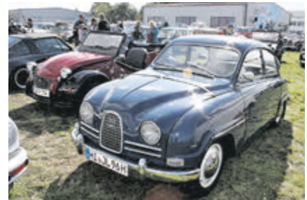
Gestatten, „Anton“: Saab 96 mit Zweitakt 850cc, Baujahr 1963, mit einem Gruppe 2 Rennmotor und knapp 80 PS. Er wurde in Schweden erfolgreich für Eisrennen auf zugefrorenen Seen eingesetzt.
