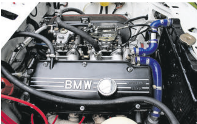
Der 2-Liter-Motor leistet heute dank Schmiedekolben, Sportnockenwelle und 45er Weber Doppelvergasern ordentliche 165 PS. Mindestens.
