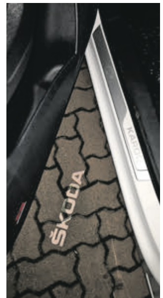
Nettes Gimmick: LED's in den Fronttüren projizieren den Skoda-Schriftzug auf den Boden.
