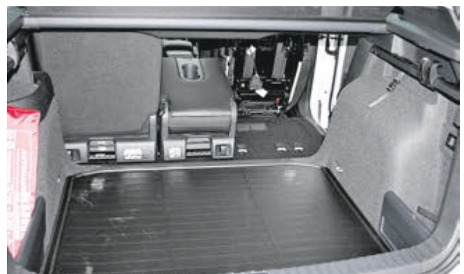
Verschieben, umlegen, vorklappen, ausbauen: Sitz-Origami dank Varioflex – und ein variables Kofferraumvolumen von 479 bis 1810 Liter. Auch super: Die Heckklappe öffnet automatisch und die „Hutablage“ schwingt beim Öffnen mit nach oben.
