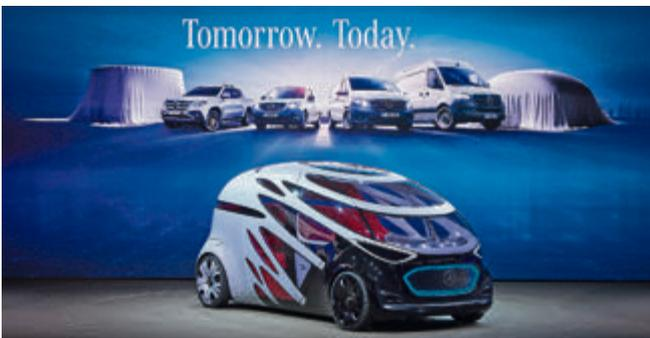
Wie der Transporter von übermorgen aussehen könnte, zeigte die Studie Vision URBANETIC von Mercedes-Benz. Basis ist ein autonom fahrendes und vollelektrisch angetriebenes Chassis in vollkommen neuem Design, das sich mit Wechsellaufbauten für Gütertransport und Personenbeförderung den individuellen Anforderungen und unterschiedlichen Aufgaben im urbanen Bereich anpassen kann.
