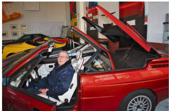
„So einfach zu öffnen wie ein Schiebedach“: Tresers geniale Konstruktion des versenkbaren Hardtops an seinem Quattro Roadster war wegweisend für die heutigen Klappdach-Cabrios und verschaffte ihm einen Entwicklungsauftrag bei Mazda.
