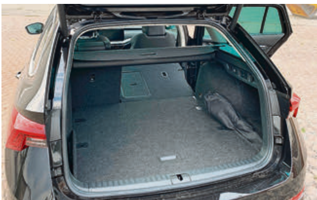
Lagerhalle: Das Kofferräumvolumen des neuen Octavia ist im Vergleich zum Vorgänger nochmals gewachsen, auf jetzt 640 bis 1700 Liter.
