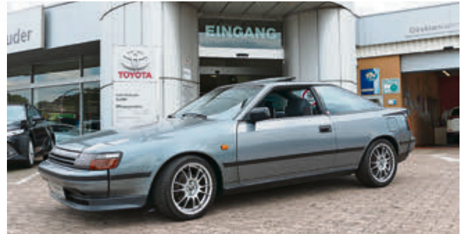
Die vierte Celica-Generation (T160) war Mitte der 80er-Jahre mit Kat, 16-Ventiler und Frontantrieb seiner Zeit voraus.
