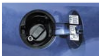
Der Erdgas- neben dem Benzineinfüllstutzen
