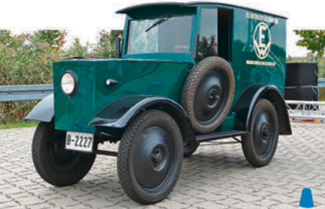
HAWA EM 3 – Ein einsitziger Stadtlieferwagen mit Elektroantrieb, gebaut 1922 von der Hannoverschen Wagon-Fabrik und restauriert von den Hanomag-Freunden.
