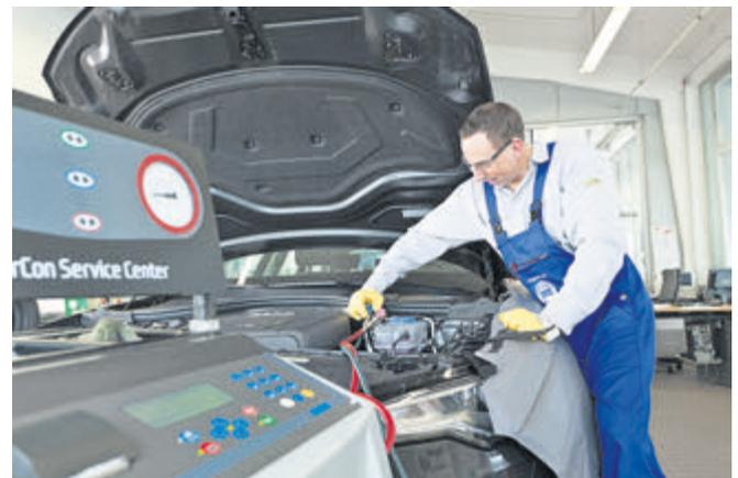
Alle zwei Jahre rät die Werkstatt zu einer Wartung der Klimaanlage. Auch deshalb, weil das System jährlich rund 15 Prozent Kältemittel verliert. Foto: ProMotor/T.Volz
