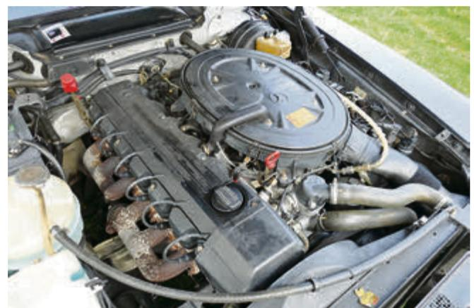
Der 3-Liter Reihensechszylinder leistet 180 PS und ist gut für etwa 200 km/h.
