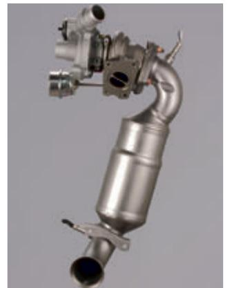
Begehrtes Gut: Ein Katalysator ist voller wertvoller Edelmetalle (im Bild mit einem Turbolader aus einem älterem BMW). Foto: BMW
