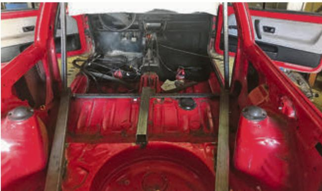
Foto vor der Fertigstellung: Hier erkennt man die Verstärkungen für die Aufnahme des Überrollbügels.
