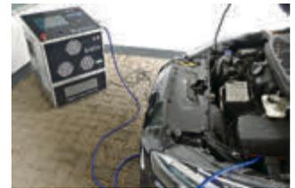
Dank Wasserstoff-Motorreinigung werden AGR-Ventil, Katalysator und Turbolader von Verkokungen befreit – ohne Ausbau der Teile.
