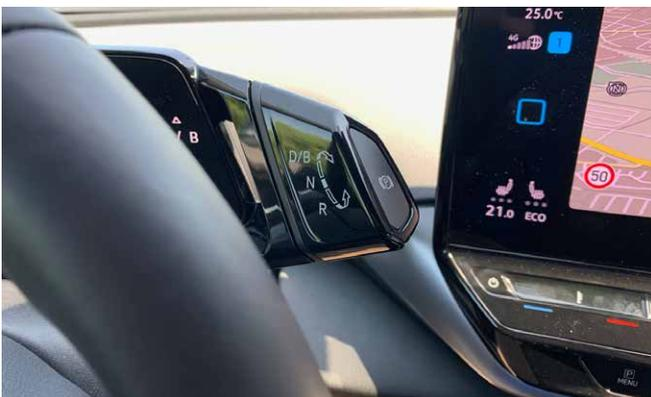
Damit Sie nachher nicht sagen können, Sie hätten's nicht gewusst: der Wählhebel für die Fahrstufen liegt etwas versteckt hinterm Lenkrad, angeflanscht an das kleine Display.
