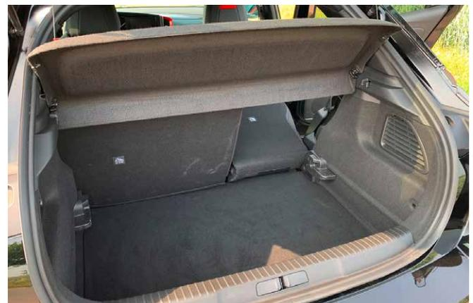
Der Kofferraum fasst 350 bis 1.105 Liter – wen die Stufe nach Umklappen der Rücksitzlehnen stört, der kann den Ladeboden höher setzen.
