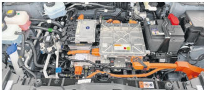
140 kW stark ist die E-Maschine, hat 360 Nm Drehmoment und verbraucht im Schnitt 16,8 kWh Strom auf 100 Kilometern.
