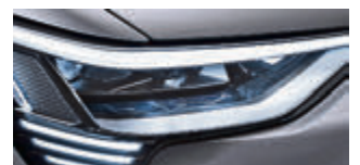
Matrix-LED-Scheinwerfer ermöglichen entspanntes Fahren mit Fernlicht. Eigentlich... Foto: Audi
