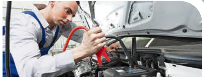
Die Autobatterie kann in der Werkstatt einfach auf Speicherkapazität, Ladezustand und die Kaltstromfähigkeit geprüft werden. Foto: ProMotor/T.Volz
