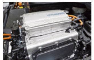
Die Brennstoffzelle im Hyundai Nexa.
