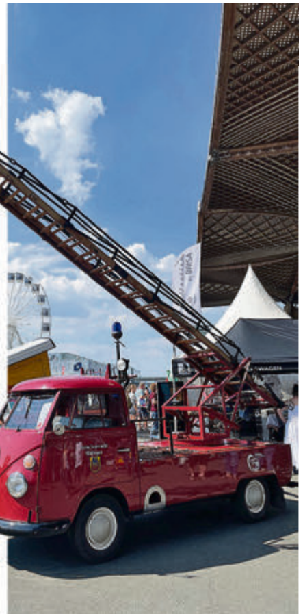
Die Pritsche des Bullis eignete sich gut für Umbauten: Hier mit einer auf 12 Meter ausfahrbaren Drehleiter aus dem Jahr 1964.
