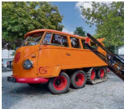
Ein KK Raupenfuchs von 1962 – konstruiert von einem österreichischen Ingenieur zur Versorgung von Alm- und Skihütten.
