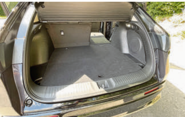
Der Gepäckraum fasst 370 bis 1.291 Liter. Die elektrische Heckklappe öffnet sich, wenn man den Fuß unter den hinteren Stoßfänger hält und verriegelt sich automatisch, sobald der Nutzer sich entfernt.
