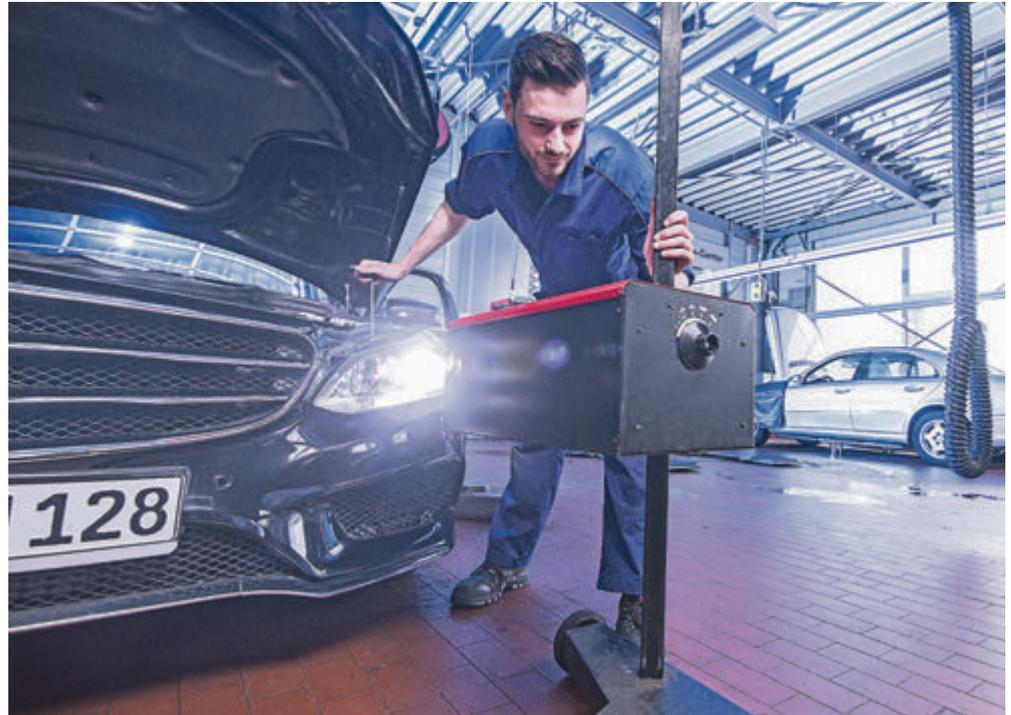
Beim Licht-Test werden neun Beleuchtungspunkte auf Sicht und Funktion sowie die Einstellung aller Lichtsysteme gecheckt. Bild: ProMotor/T.Volz
