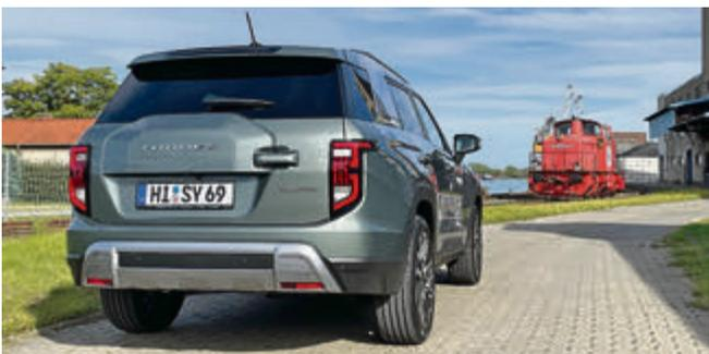
Das Heck mit ange deuteter Reserverad-Abdeckung. Der nach rechts versetzte Griff der Kofferraumklappe suggeriert ein seitliches Öffnen – die Klappe schwingt aber ganz praktisch nach oben auf.
