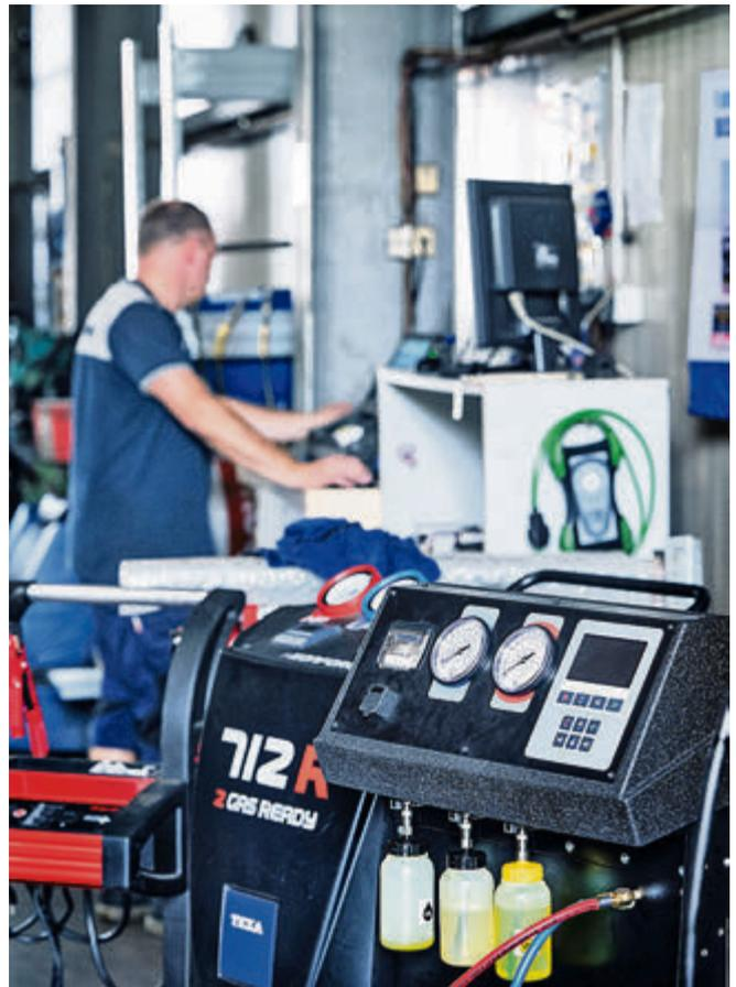
Die Klimaanlage sollte alle zwei bis drei Jahre gewartet werden. Denn mit der Zeit verliert sie Kühlflüssigkeit, die Wirkung lässt nach. Die Werkstatt checkt auch die Dichtigkeit und desinfiziert den Verdampfer. Bild: ProMotor
