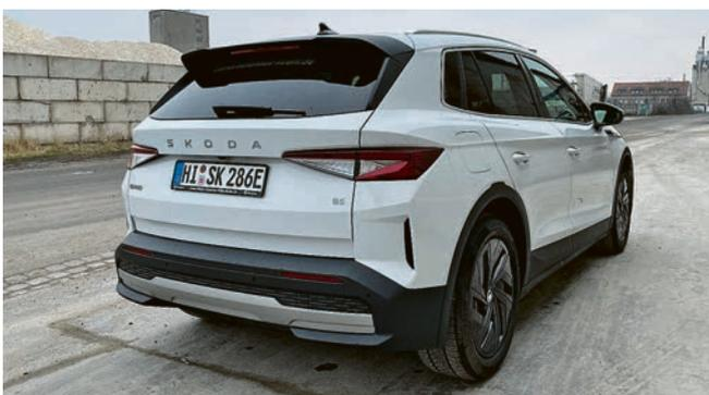
Die sanft abfallende Dachlinie, der mit Finnen versehene Dachspoiler und zahlreiche Detailoptimierungen tragen zur guten Aerodynamik von cW 0,26 bei.
