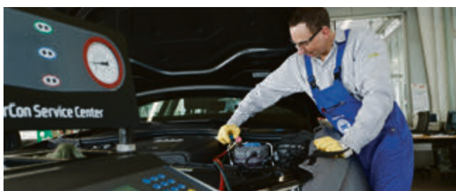
Alle zwei Jahre rät die Werkstatt zu einer Wartung der Klimaanlage. Auch deshalb, weil das System jährlich rund 15 Prozent Kältemittel verliert. Foto: ProMotor/T.Volz
