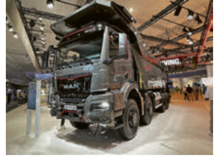
Mining Kipper für den harten Einsatz: MAN TGS 60.540 mit 540 PS und 2.650 Nm maximalem Drehmoment.
