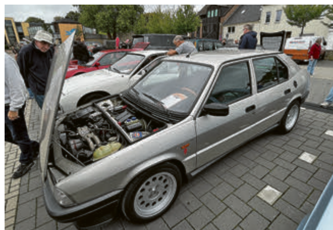
Dieser Alfa Romeo 33 aus dem Jahr 1989 zeigt stolz seinen 107-PS Boxermotor.
