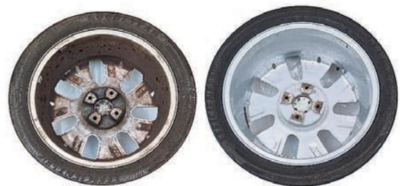
Vorher – Nachher: Dank Ultraschall-Reinigung wird selbst eingebrannter Bremsstaub gelöst.
