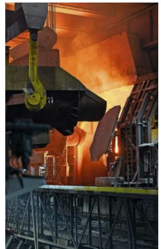
Der flüssigen Stahlschmelze können unterschiedliche Legierungselemente beigemischt werden – dadurch ändern sich die Eigenschaften des Stahls. Foto: Audi
